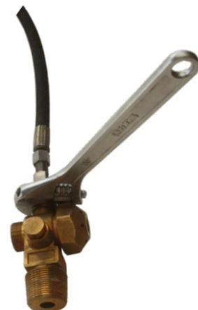
图 29 拧紧高压软管及接头
