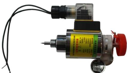
图 21 取下电磁型驱动装置
