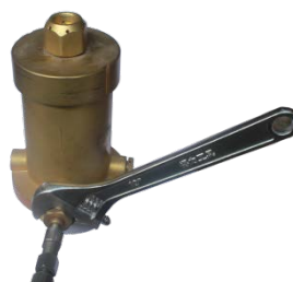
图 37 铜合金灭火剂瓶组容器阀上拆卸软管
