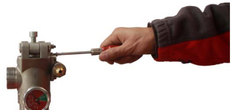
图 23 逆时针旋出灭火剂瓶组容器阀（不锈钢）上的保险销
