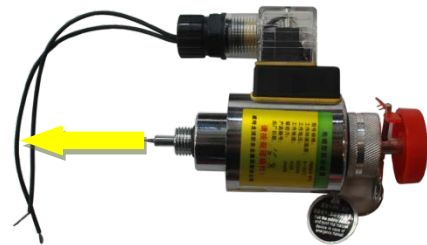
图 19 阀针弹出，声音清脆无滞
