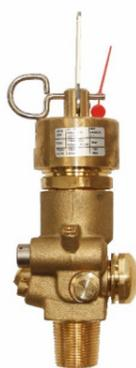
灭火剂容器阀装配在灭火剂贮存容器上，具有封存、释放、充装、超压排放、检漏等功能，出口与连接管相连；在发生火情时，通过驱动气体推动执行机构动作，使灭火剂容器阀开启并释放灭火剂。灭火剂容器阀上设有压力表及配套检修机构、机械应急操作装置；同时设置有安全保险机构，可以有效防止设备运行、维护过程中及运输安装等过程中的误操作。
