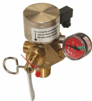
驱动气体容器阀装配在驱动气体贮存容器上，具有封存、释放、充装、超压排放、检漏等功能，出口与驱动气体管路相连；在发生火情时，接收灭火指令，驱动气体容器阀开启，释放驱动气体，开启选择阀及灭火剂瓶组，释放灭火剂。驱动气体容器阀上设有压力表及配套检修机构、机械应急操作装置；同时设置有安全保险机构，可以有效防止设备运行、维护过程中及运输安装等过程中的误操作。
